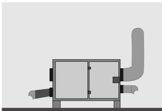
O desumidificador dessecante é projetado para facilitar a conexão de dutos. Para inspeção e manutenção, por favor, assegure-se de que há espaço suficiente ao redor do equipamento. Isso é para garantir folga ao abrir a porta de acesso e remover a roda dessecante.
