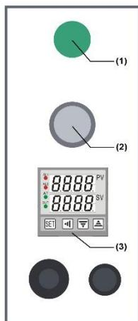
① **Liga/Desliga:** Pressione uma vez para ligar o equipamento. Para desliga-lo pressione novamente.
