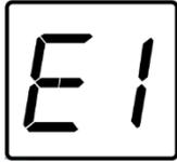
compressor se assegure de que o intervalo de início em relação ao término não seja menor do que três minutos. Quando o sensor de temperatura ou umidade tiver problemas, o código de erro “E1” ou “E2” piscará no visor para informar a necessidade de
