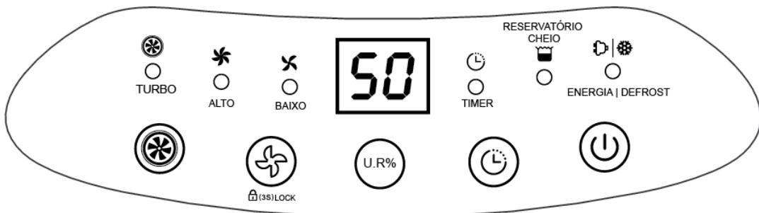
**Encendido / Apagado** : Pulse el botón una vez para encender y apagar el aparato.
