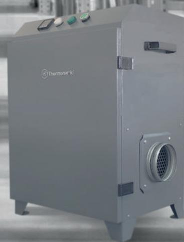
Por meio de seus sistemas, o dessecante remove a umidade do ar através do princípio da adsorção. Isso é feito com o auxílio de um rotor dessecativo, construído com material corrugado, um componente que facilmente atrai e retém o vapor de água.
