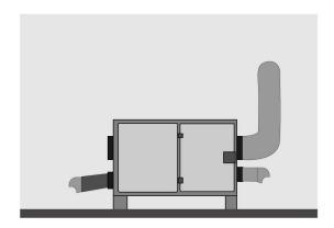
O desumidificador dessecante é projetado para facilitar a conexão de dutos. Para inspeção e manutenção, por favor, assegure-se de que há espaço suficiente ao redor do equipamento. Isso é para garantir folga ao abrir a porta de acesso e remover a roda dessecante.
